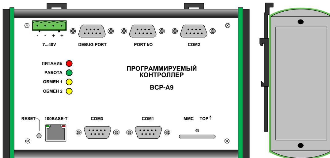
Рисунок 1 Внешний вид контроллера ВСП-А9 и расположение разъёмов
